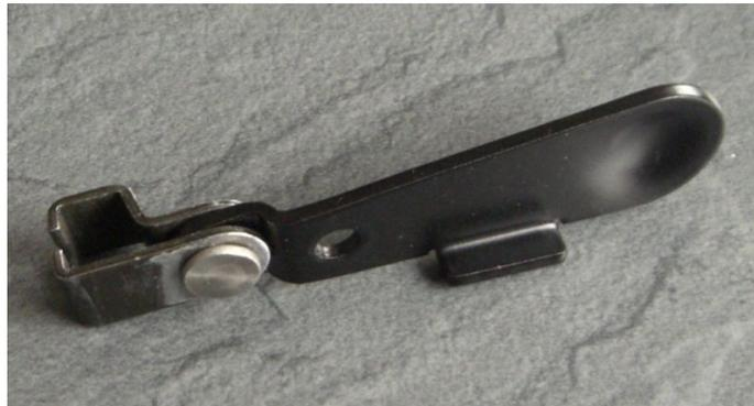
drehen das Ganze um, ohne dass es zerfällt und legen den Nietkopf auf eine harte Unterlage (Amboss, Schraubstock, dicker Hammerkopf). Körner in das kleine Loch der Niete stecken und mit dem Hammer drauf hauen. Dadurch weitet sich die Niete auf und kann nicht mehr raus. Das Bügelchen soll noch beweglich bleiben, nicht zu fest schlagen, zur Not noch mal drauf hauen.
