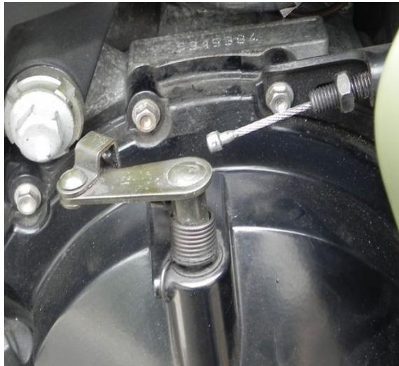
Mit dem Dremel und einem Schleifsteinchen oder Kugelfräser drin schleifen wir den kleinen unteren Kopf der Niete weg, alternativ mit der Bohrmaschine. Den oberen Kopf an- und dann wegbohren halte ich für das mühsamere Geschäft. Rest der Niete entfernen.
