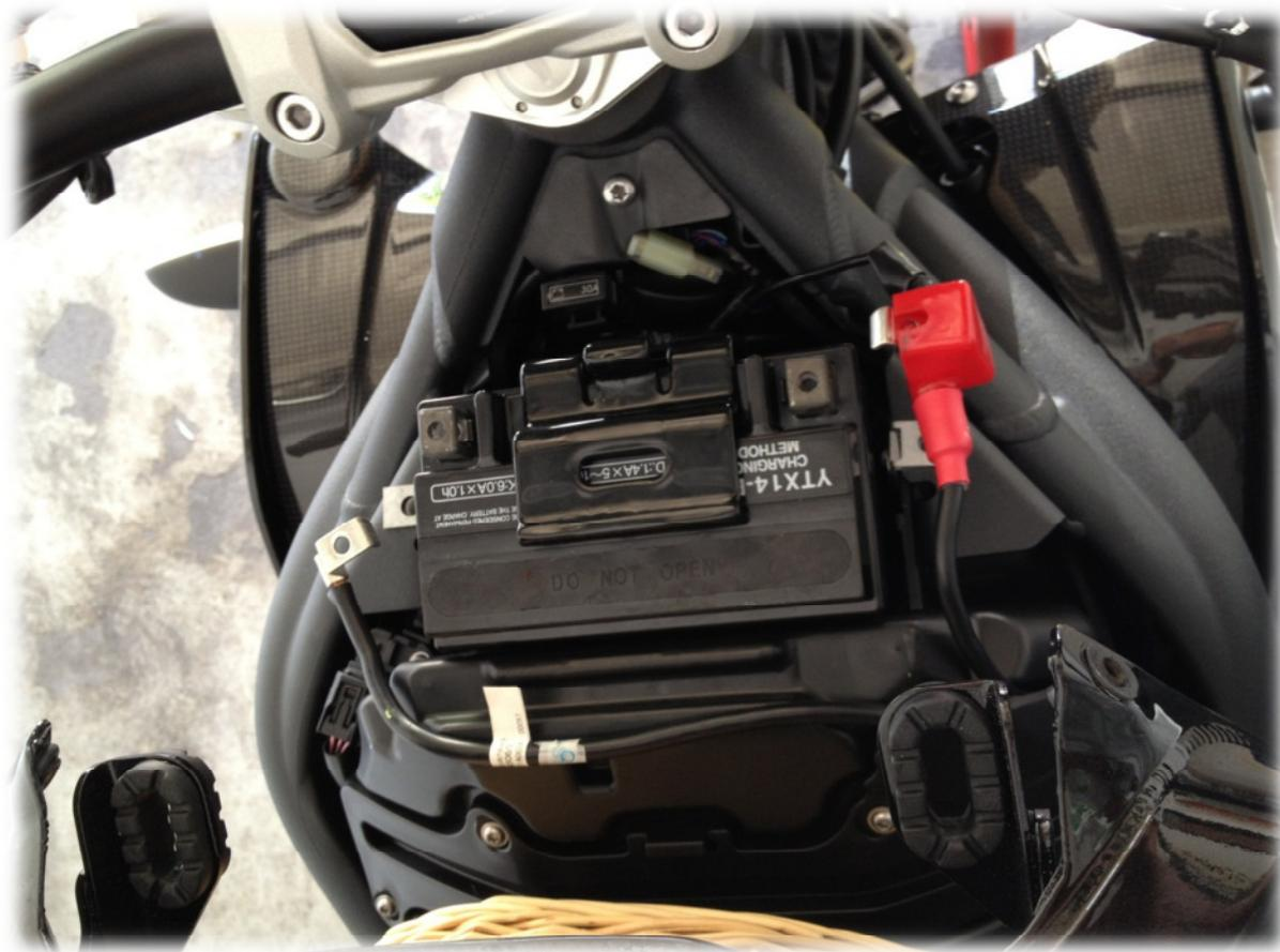
Die Demontage der originalen Batterie ist denkbar einfach, nur das Heraushebeln der Batterie im Anschluss bedarf ein wenig Geschicks.
