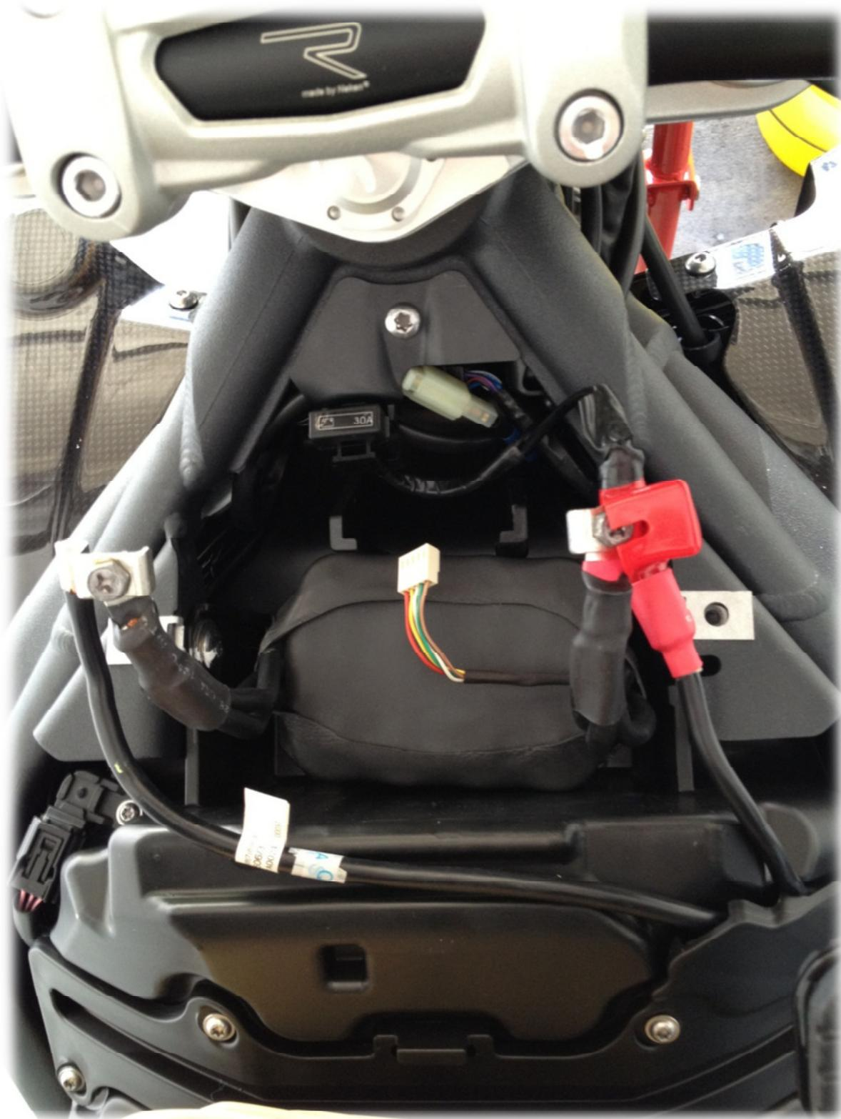
Bevor der Tankdeckel montiert werden kann, sollte man das originale Gummiband in den kleinen Spalt drücken, so dass die Batterie nun exakt sitzt und nicht mehr verrutschen kann. Somit geht der Gummi, falls wieder retour gebaut werden möchte, nicht verloren und erfüllt so seinen Zweck.
