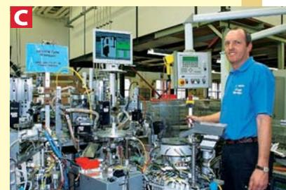
**Marktführer Philips produziert pro Jahr viele Millionen Lampen im Werk Aachen (Bild A). Eine H4-Lampe besteht aus 19 Teilen plus Füllgas. Besonderheit der Philips-Lampen: das extrem widerstandsfähige Quarzglas (B), das den Einsatz besonders heißer (und damit heller) Glühwendeln erlaubt. Bei jeder Lampe wird am Monitor kontrolliert, ob Haupt- und Nebenwendel sowie Abdeckkappe richtig sitzen (C)**
