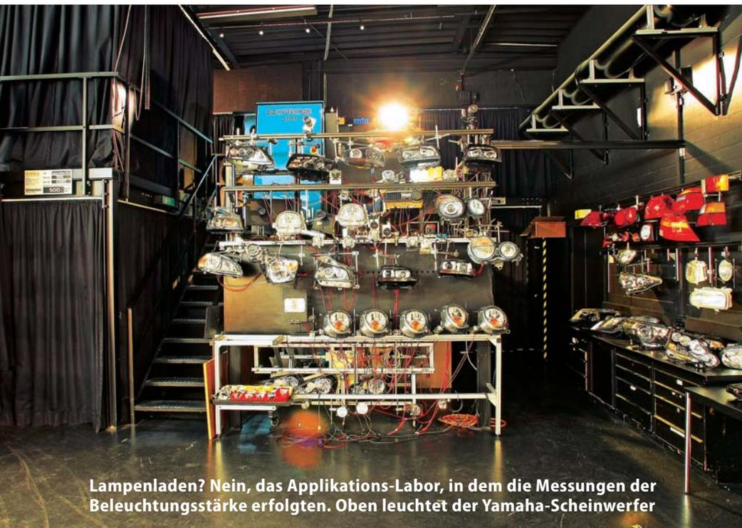
Lampenladen? Nein, das Applikations-Labor, in dem die Messungen der Beleuchtungsstärke erfolgten. Oben leuchtet der Yamaha-Scheinwerfer
