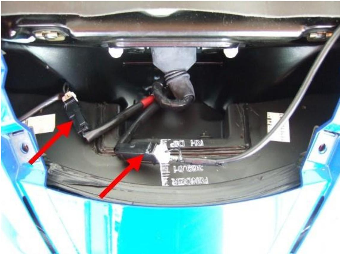
Jetzt die Spiegel entfernen. Jeder Spiegel ist von innen her mit 2 Muttern SW10 befestigt. Beide Muttern mit dem Ring-/Gabelschlüssel abschrauben und den Spiegel abnehmen. Die Stecker lassen sich problemlos durch die Verkleidung schieben.
