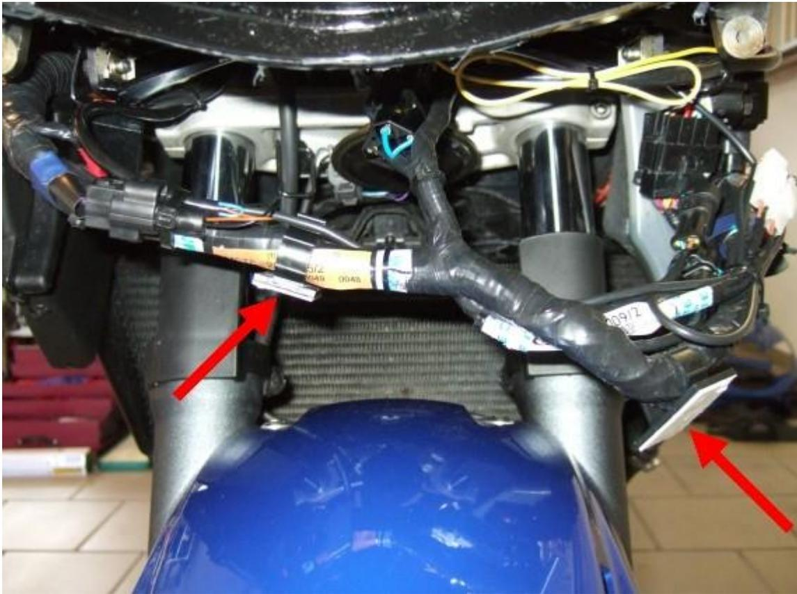
Zuletzt hängt die Frontverkleidung noch mit jeweils 3 Schrauben (Inbus 5 mm) auf jeder Seite an der Seitenverkleidung (falls nicht schon vorher abgebaut). Diese Schrauben entfernen und die Frontverkleidung nach vorne abnehmen.
