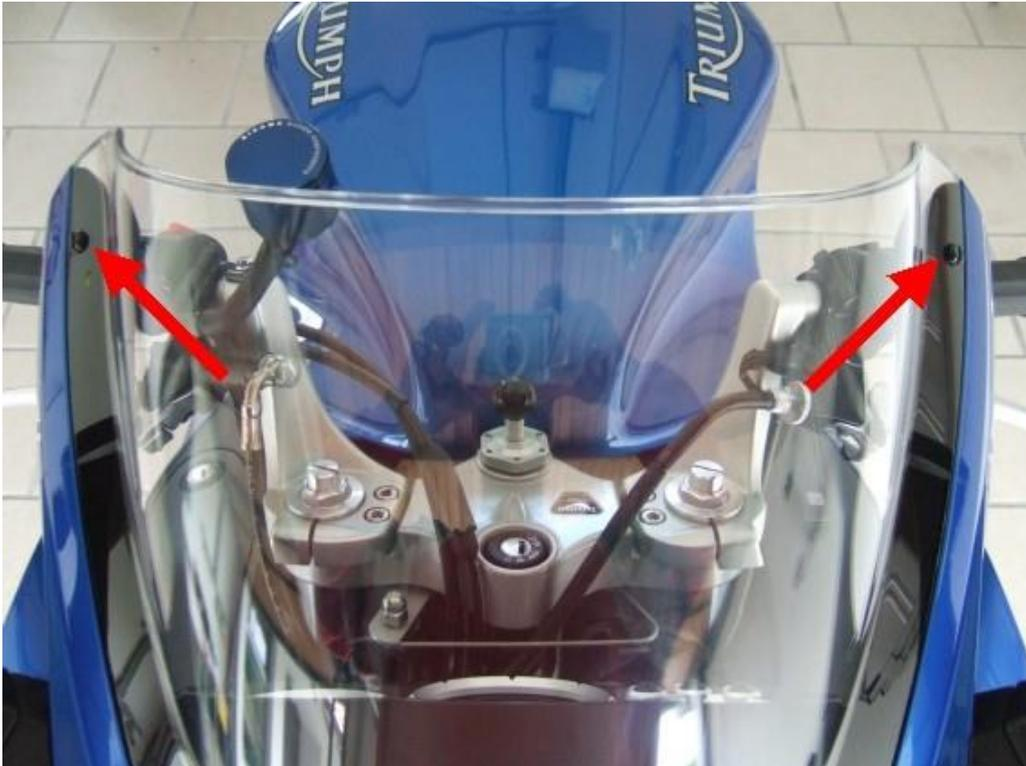
Jetzt die 4 Schrauben (Inbus 5 mm) der Unterscheibenverkleidung entfernen und die Unterscheibenverkleidung abnehmen.
