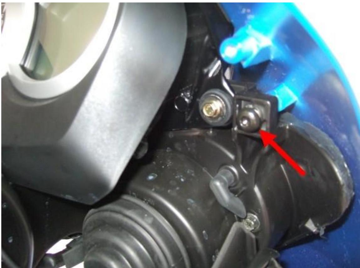
Unten in der Frontverkleidung verläuft ein Kabelbaum. Der Kabelbaum ist mit 2 Klebeschellen an der Frontverkleidung fixiert. Also entweder den Kabelbaum "ausclipsen" oder die Klebeschellen lösen (meist halten die Klebeschellen sowieso nicht mehr).
