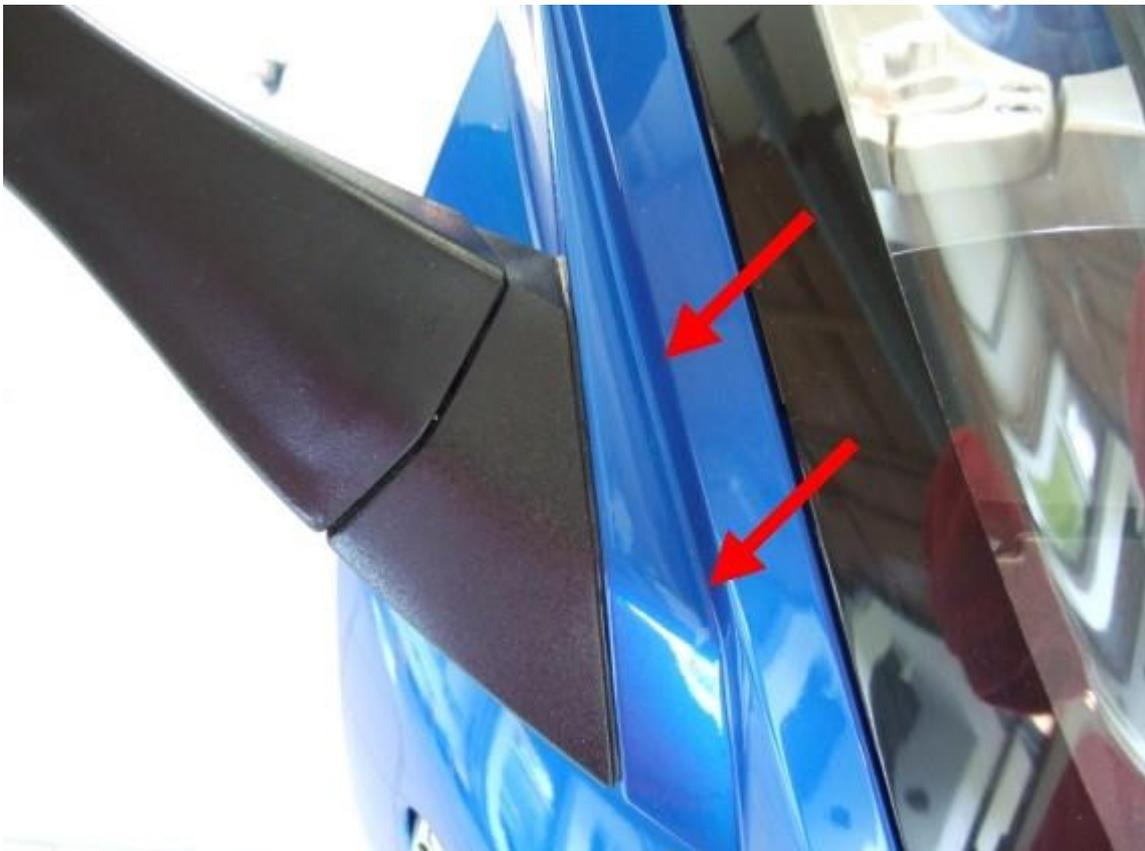
Die Verkleidung ist mit 4 Schrauben (Inbus 5 mm) von hinten an der Scheinwerfereinheit befestigt. Dies zu fotografieren ist fast nicht möglich. Ich habe auf den nächsten beiden Bildern die Position der Schrauben auf der Scheinwerfereinheit markiert.
